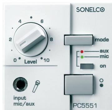
El Preamplificador para micrófono PC5551 permite la conexión a una instalación de sonido realizada con la Serie Prestige de un micrófono monofónico de cualquier tipo o bien de una fuente de sonido auxiliar estéreo (a nivel de línea). El micrófono puede conectarse tanto de forma asimétrica (convencional) o simétrica (balanceada). El preamplificador realiza además la conmutación automática entre la música ambiental existente (en su caso) y la fuente de sonido local (micro o auxiliar).
